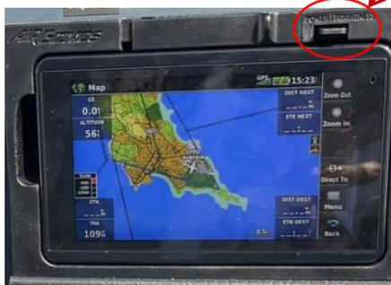
Le GPS est alimenté par le système avion, et dispose d'une batterie de secours d'une autonomie d'environ 4 heures.
