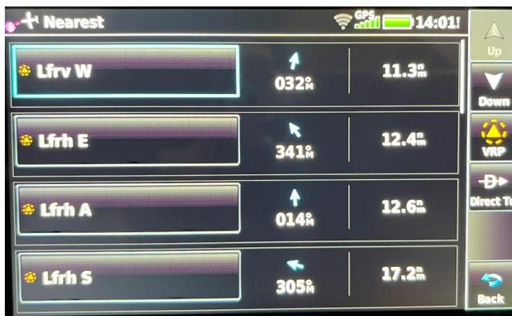
Dans cet exemple, la page nous propose en première ligne le point « W » de Vannes, la Rm et la distance pour y aller. On remarque la possibilité (si le point est sélectionné, comme ici) d'y aller en utilisant le bouton « Direct To ».
